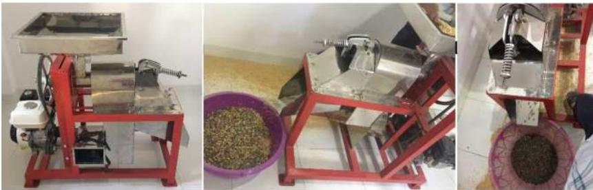
**Gambar 26.** Mesin Huller berkapasitas 100 Kg/Jam
