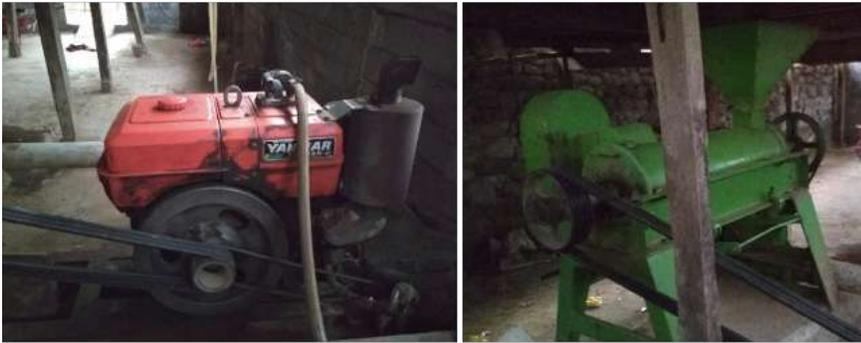
**Gambar 25.** Mesin Huller berkapasitas 1 Ton/Jam
